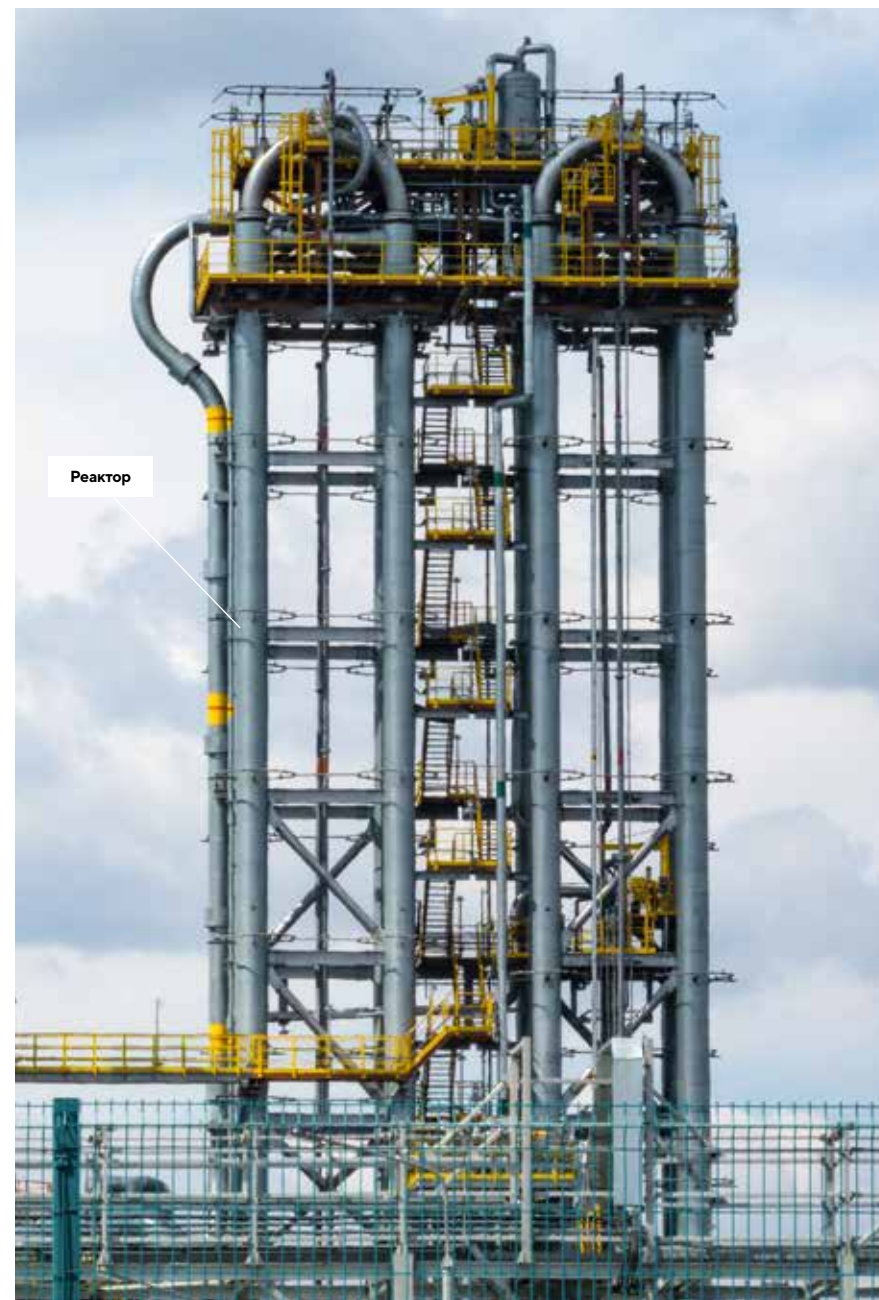
Рисунок 60. Петлевой реактор полимеризации на предприятии
