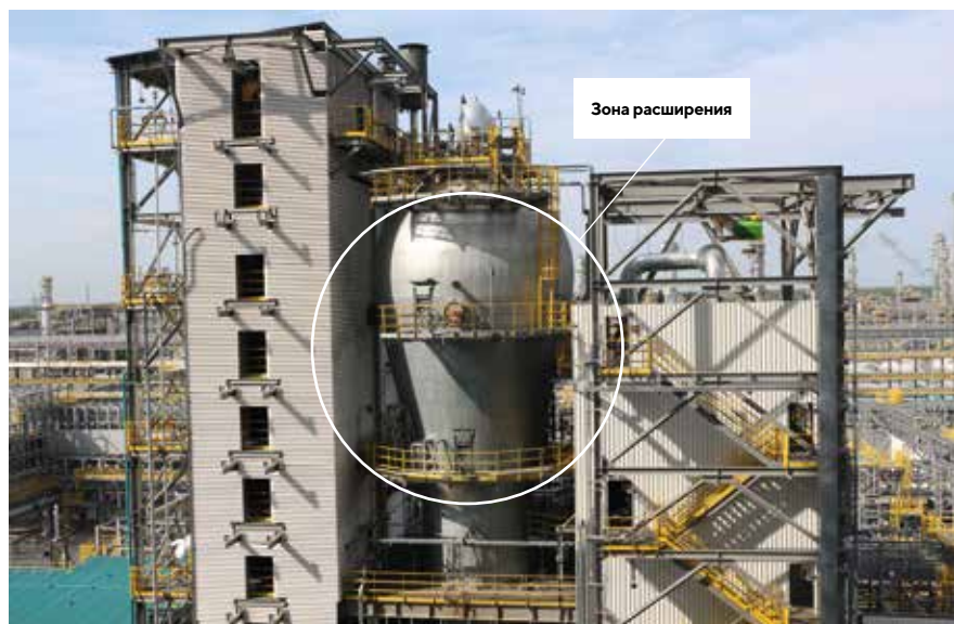
Рисунок 58. Реактор газофазной полимеризации этилена на производстве
